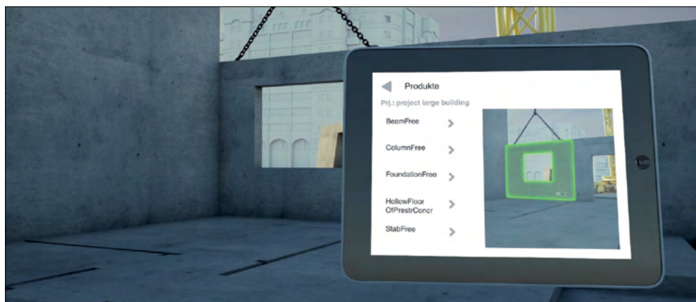
Rys. 6. Przykład zidentyfikowania elementu prefabrykowanego [6]
